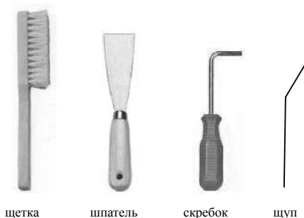
Рисунок 6.2 Комплект для монтажа труб.
