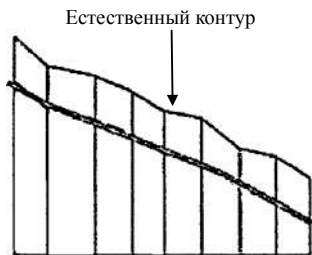
Рисунок 5.5 Трубопровод с постоянным уклоном.
