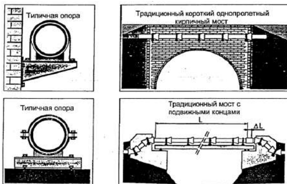
Рисунок 6.32 Трубопровод, закрепленный на сооружении.
